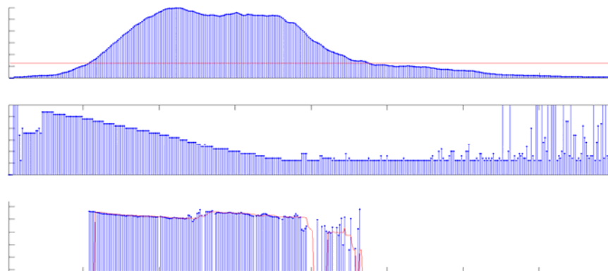
图 2 单个车辆在照射区域内停车过程的信号图
